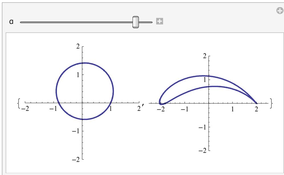
点(-1,0)を通る円(↑), 点(1,0)を通る円(↓)をジュコフスキー変換すると飛行機の翼の形に変換される。
