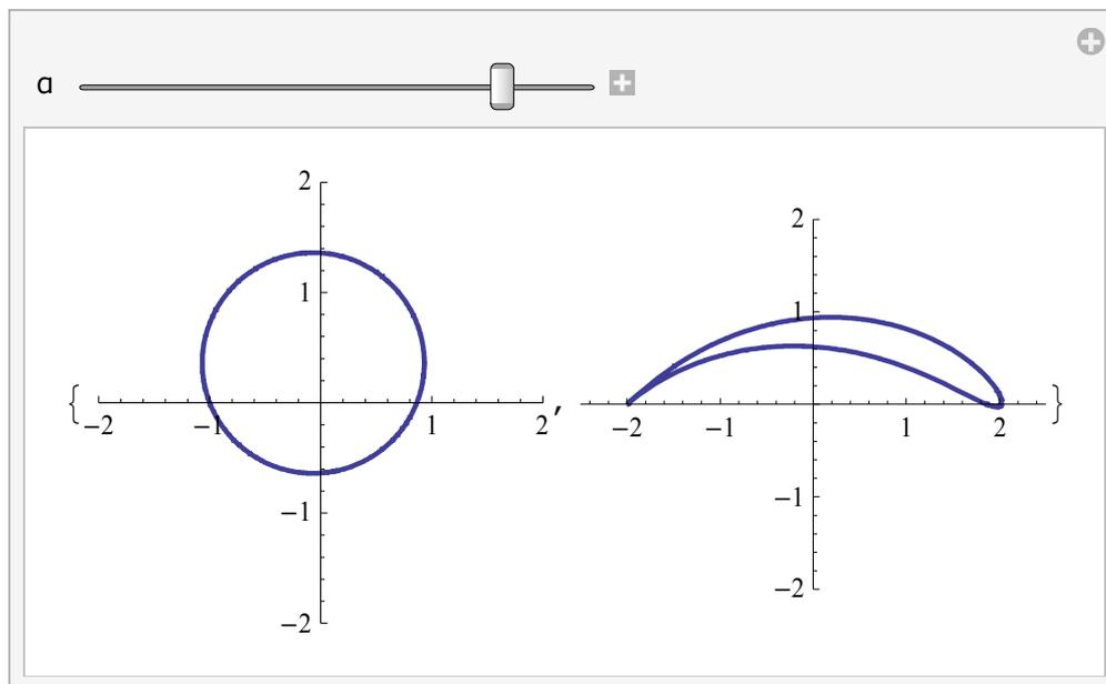
ロシアの航空学者、ニコライ・ジュコフスキーはこの変換を利用して、円柱のまわりの空気の流れを翼形の周りに変換する研究し、翼の揚力を発生させるメカニズムを理論化して「クッタ・ジュコフスキーの定理」を発表して等角写像による飛行機の翼の理論を発展させた。Su-27やMig-29などの運動性能の高い戦闘機を開発し、ロシアの航空工学を発展させた。
