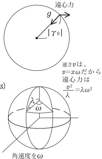
となり、これは重力加速度  $9.81(\text{m/s}^2)$  の  $\frac{1}{410}$  倍しかない。私たちは重力加速度と遠心力の合力を地球の重力として感じていますが、実際には遠心力は無いに等しい程のものである。
