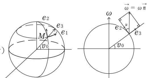
$$\vec{\omega} \times \vec{v} = (\omega \cos v_0 \frac{dz}{dt} - \omega \sin v_0 \frac{dy}{dt}) e_1 + \omega \sin v_0 \frac{dx}{dt} e_2 - \omega \cos v_0 \frac{dx}{dt} e_3$$
