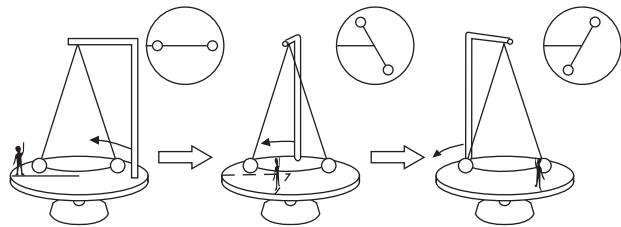
振動面の向きは変わらないため、回転盤上では振動面が回転して見える。
