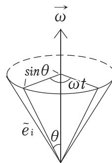
結局  $\frac{d\tilde{e}_i(t)}{dt}$  の成分 (方向) から回転軸  $\vec{\omega}(t)$  が定まりさらに  $|\vec{\omega}(t)|$  が回転の角速度を表していることになる。
