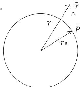
(11) における質点にかかる外力  $F$  にはつねに  $-\tilde{e}_3$  方向の重力  $-m\vec{g}$  が含まれている。 $\tilde{S}$  系の原点  $\tilde{P}$  には自転による東向きの自転のため遠心力が働く。この遠心力は実は重力加速度と比較すると無視できる程小さいことを次に示す。点  $\tilde{P}$  と地軸との距離を  $\lambda$ 、北緯を  $v_0$  地球の半径を  $|\gamma_0|$  とすると
