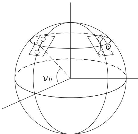
図は、北緯 $\nu_0$ の1点Pで真北に向けて振った振り子が地球の自転により点Qの位置に来たときの振り子の方向を表しています。一方、点Pでの振り子の振る方向をベクトルと考えそれを北緯 $\nu_0$ の緯線に沿って点Qまで平行移動したものは、丁度点Qの振り子の方向と同じなのではないか。こんな疑問に取り付かれ、数学と物理の両方から調べてみました所、この2つの方向が同じであることを確認することができましたので、紹介します。
