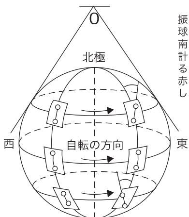
振動面は、北半球では時計回り、南半球では反時計回りに回転するように見える。赤道上では回転しない。
